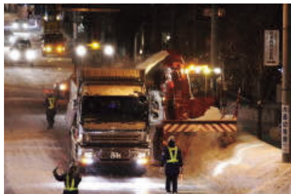
大型ロータリ除雪車による排雪の様子
