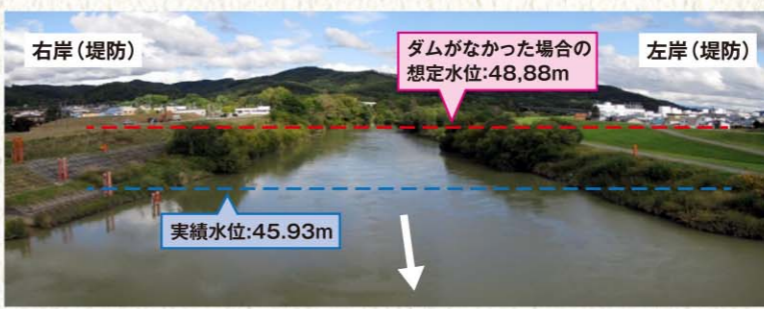
金山ダム下流の空知川(赤平水位観測所)において「ダムがなかった場合の想定水位」は堤防の高さに迫っており、ダムがある現状の「実績水位」を大きく上回っている。
