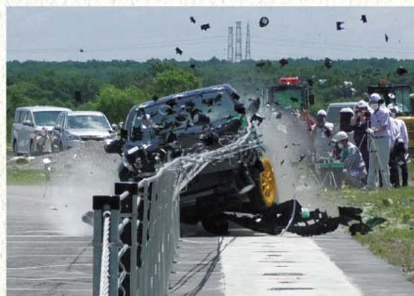
試験道路で行われたワイヤロープ防護柵の実験。平成30年度国土技術開発賞優秀賞、平成30年度土木学会技術開発賞を受賞。特許も取得している。写真提供=寒地土研
