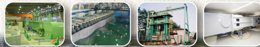
絶え間なく水を流し、さまざまな水理実験を支える高圧循環水路実験装置 多方向から波浪を発生させ三次元的に再現する多方向造波大水深平面水槽 供試体に載荷をかけて構造物の耐力や疲労試験を行う油圧サーボ試験機 最大50Gの遠心加速度をかけて変形や破壊挙動試験を行う遠心力載荷装置
