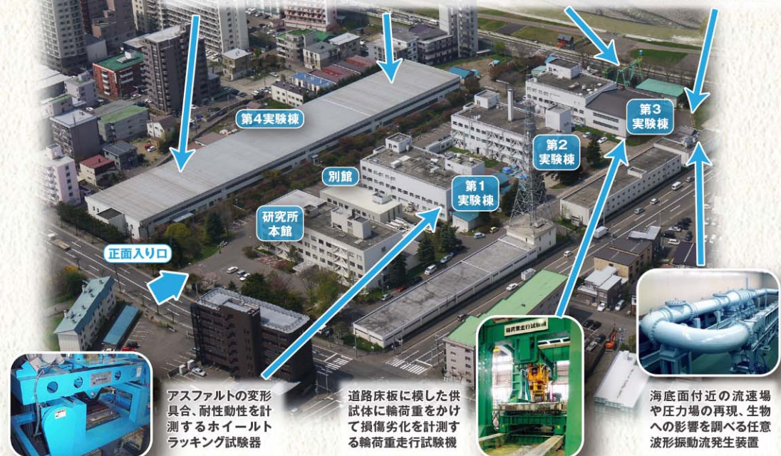
絶え間なく水を流し、さまざまな水理実験を支える高圧循環水路実験装置 多方向から波浪を発生させ三次元的に再現する多方向造波大水深平面水槽 供試体に載荷をかけて構造物の耐力や疲労試験を行う油圧サーボ試験機 最大50Gの遠心加速度をかけて変形や破壊挙動試験を行う遠心力載荷装置
