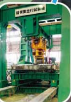
道路床板に模した供試体に輪荷重をかけて損傷劣化を計測する輪荷重走行試験機
