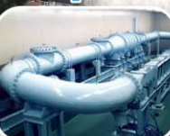
海底面付近の流速場や圧力場の再現、生物への影響を調べる任意波形振動流発生装置
