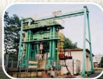
供試体に載荷をかけて構造物の耐力や疲労試験を行う油圧サーボ試験機
