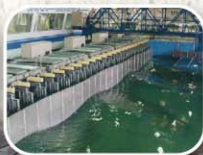
多方向から波浪を発生させ三次元的に再現する多方向造波大水深平面水槽
