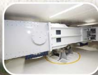
最大50Gの遠心加速度をかけて変形や破壊挙動試験を行う遠心力載荷装置
