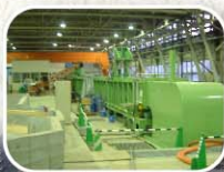
絶え間なく水を流し、さまざまな水理実験を支える高速循環水路実験装置
