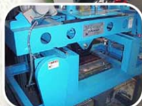
アスファルトの変形具合、耐性動性を計測するホイールラッキング試験器
