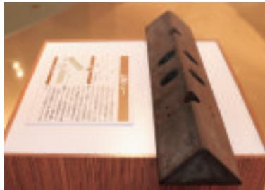
ながら、昭和29年（1954）に三角形断面の履板を装着し、接地圧を低下させたブルドーザの改良に成功しました。
